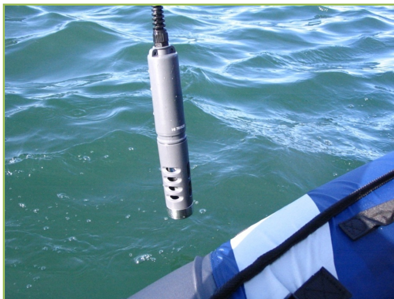
Figura 3.1.3-7: Sonda multiparamétrica utilizada durante a campanha.
