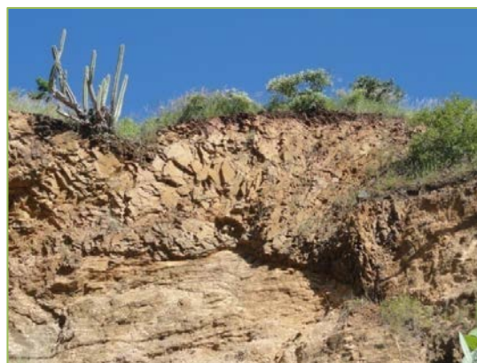
Talude apresentando desmoronamento em perfil de rocha pouco alterado da Unidade Forte São Mateus
