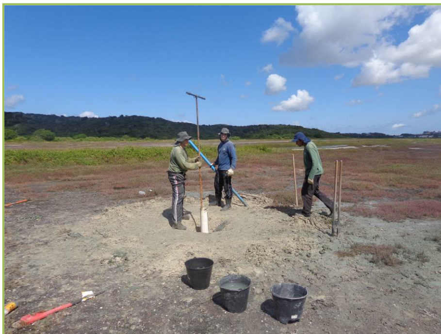
Figura 3.1.8-2: Trado utilizado para perfuração.
